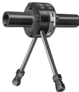
Messrohr Typ 91 Messflansch mit Normblende und Ringkammer mit angeschweißten kalibrierten Rohren · DN 15 bis 50 · PN 25
