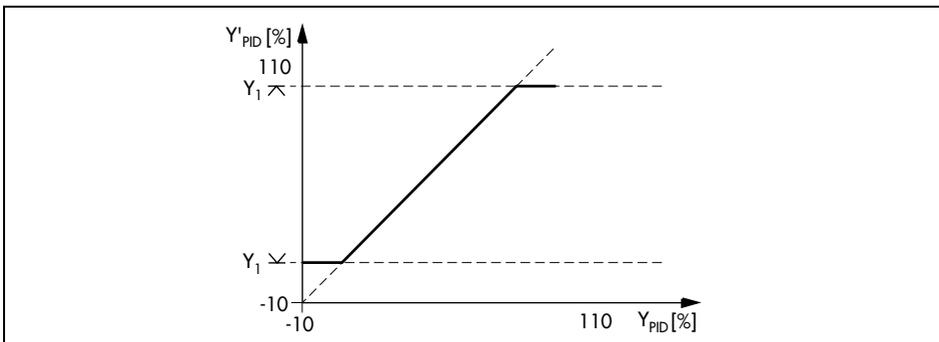
Fig. 51 · Limitation of  $Y_{PID}$  via C35-5
