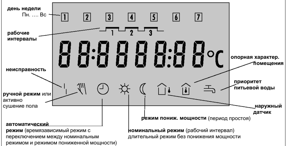
Рис.2 • Уровни функционирования регулятора и символы индикации
