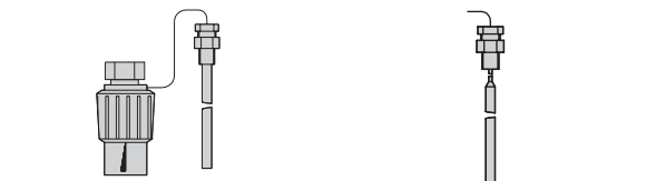
Sensor de temperatura con funda de protección con enlace por prensaestopas Fig. 1 · Termostatos en sus distintas ejecuciones
