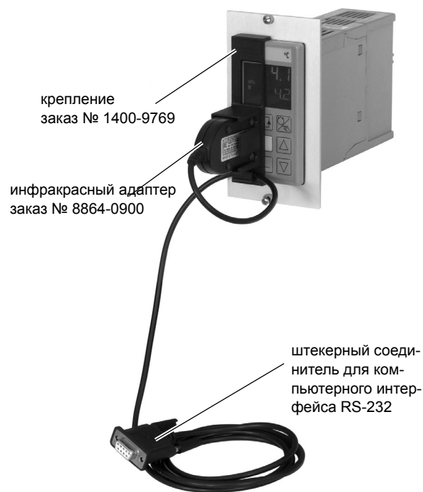
Рис. 4: Подключение инфракрасного адаптера
