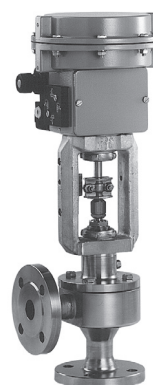
Fig. 2 · Valvola Tipo 3249-7 in versione speciale con premistoppa di sicurezza, corpo in materiale pieno con flange, attuatore pneumatico Tipo 3277-5 e posizionale i/p integrato Tipo 3767
