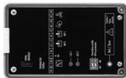
Rys. 17 · Ustawnik pozycyjny typu 3787 po otwarciu obudowy
