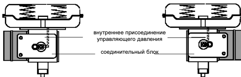
Рис. 11.1 • Направление действия >>, монтаж слева
