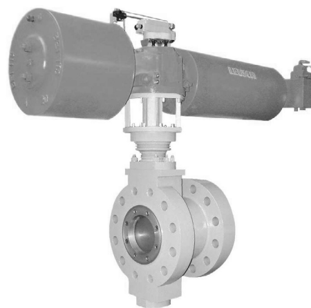
Fig. 1 · Vanne papillon haute pression type LTR 43 exécution double bride, NPS 10, Class 1500 avec servomoteur pneumatique et positionneur
