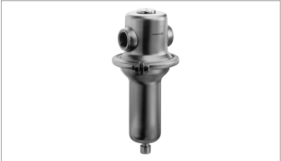
Bild 1 · Überströmventil Typ M 44-7, Anschluss G 1, Kvs-Wert 3,6
