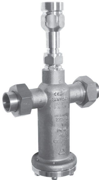
Typ 2357-3 mit Rückschlagereinheit an Anschluss C · Anschlüsse A und B mit Lötnippel mit Kugelbuchse
