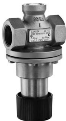
Riduttore per vapore tipo 44-0 B, corpo filettato, bronzo rosso
