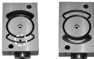
Fig. 10 · Bloc de liaison CNOMO (Position du joint réversible à gauche pour l'alimentation d'air interne et à droite pour l'alimentation d'air externe)
