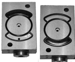
Рис. 10 ■ CNOMO интерфейс; положение реверсивного уплотнения для внутренней (слева) и внешней (справа) подачи давления питания
