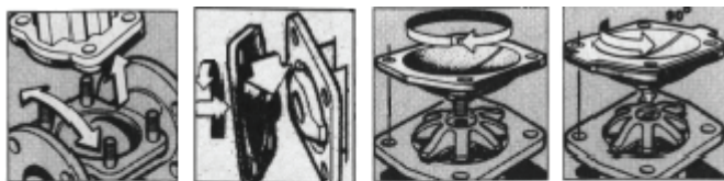
Membrana con connessione a nipplo, avvitata o a baionetta (1/4 di giro)
