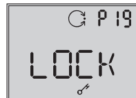
LOCK und Schlüssel-Symbol zeigen an, dass die Konfiguration gesperrt ist.
