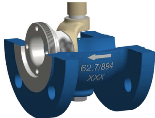
Bild 4: Kegelbewegung bei doppel-exzentrischer Lagerung
