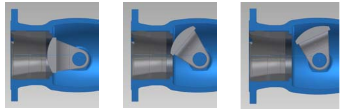
Bild 3 Kegelbewegung bei doppel-exzentrischer Lagerung
