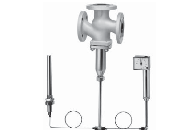
Рис. 2: Регулятор температуры типа 9 с регулирующим термостатом типа 2232, исполнение с раздельной установкой заданного значения
