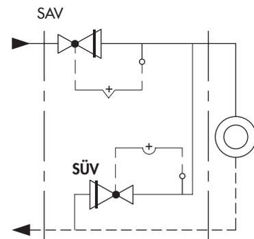
**Bild 1:** Absicherung einer Hausstation mit SAV und SÜV
