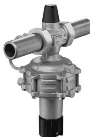
Fig. 2 · Régulateur de débit et de pression différentielle type 46-7 DN 15 à 25, plages de consigne 0,1 ... 0,5 et 0,5 ... 1 bar
