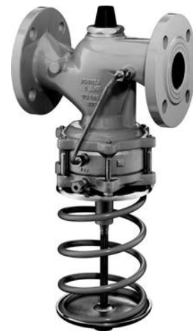
Рис. 1. · Регулятор расхода и перепада давления или регулятор давления Тип 47-1, DN 15 до 32, исполнение с ручным задатчиком для установки заданных значений \Delta p и с наружной крышкой со шкалой для установки заданного значения расхода, клапан с патрубками под приварку.
