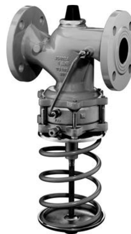
Рис. 1. · Регулятор расхода и перепада давления или регулятор давления Тип 47-1, DN 15 до 32, исполнение с ручным задатчиком для установки заданных значений \Delta p и с наружной крышкой со шкалой для установки заданного значения расхода, клапан с патрубками под приварку.
