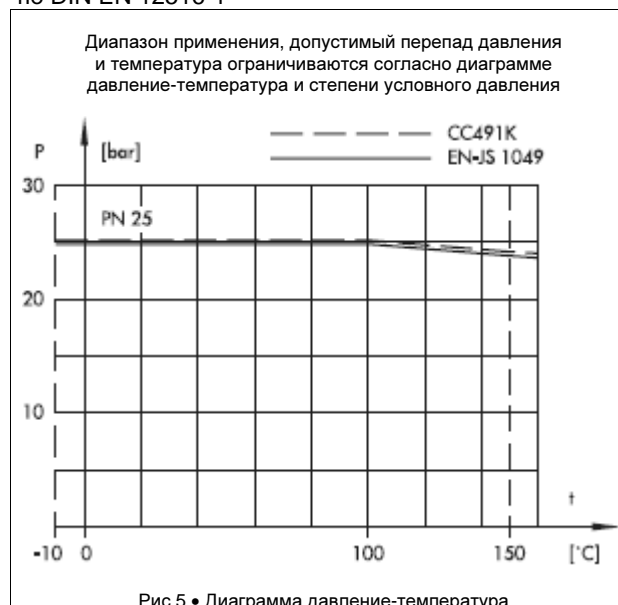
Диаграмма давление-температура по DIN EN 12516-1
