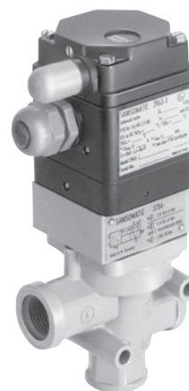
Electrovanne 3/2 voies, à fonction monostable, avec ressort de rappel, coefficient K_{vs} 4,3, raccord G 1/4
