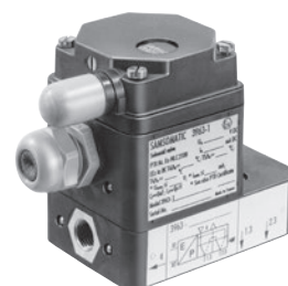
Electrovanne 5/2 voies, à fonction monostable, avec ressort de rappel, coefficient K_{vs} 0,16, raccord G 1/4
