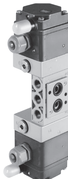
Electrovanne 5/2-voies, à fonction bistable, avec 2 positions bloquées mécaniquement, coefficient K_{vs} 1,4, raccord G 1/4/NAMUR
