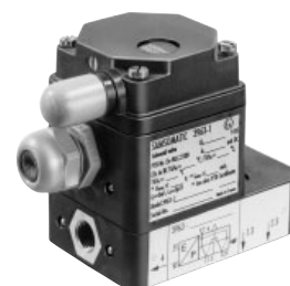
5/2-weg magneetventiel, eenzijdig aangestuurd, met veerretour, K_{vs} -waarde 0,16, aansluiting G 1/4
