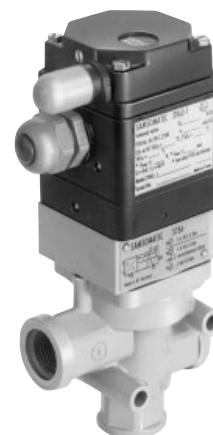
3/2-weg magneetventiel, eenzijdig aangestuurd, met veerretour, K_{vs} -waarde 4,3, aansluiting G 1/4
