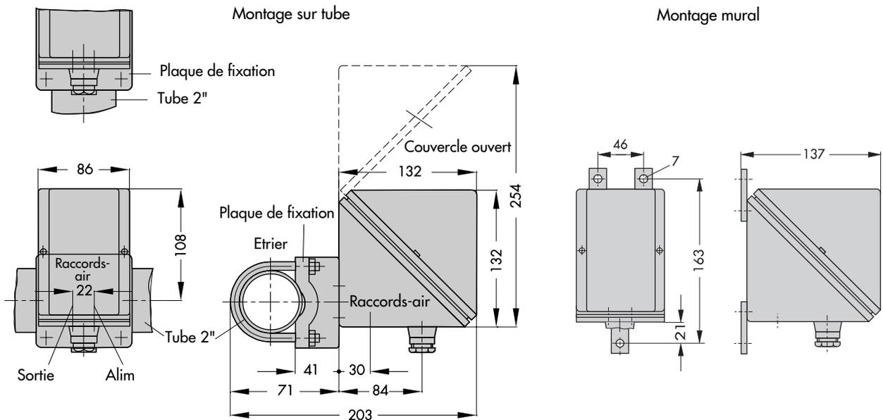
**Appareil en boîtier pour montage en armoire type 6102-4
