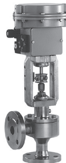
Bild 2: Stellventil Typ 3249-7 in Sonderausführung mit Sicherheitsstopfbuchse, Vollmaterialgehäuse mit Flanschen, pneumatischem Antrieb Typ 3277-5 und integriertem i/p-Stellungsregler Typ 3767
