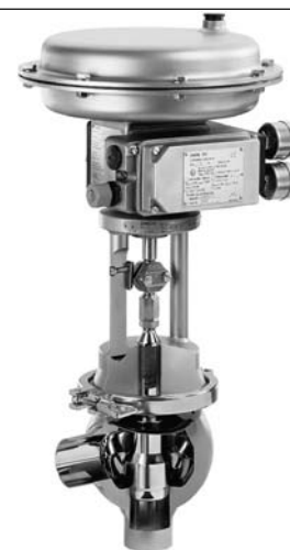
Fig. 1 · Válvula de control Tipo 3249-7 ejecución con cuerpo ball-body, cuerpo en bloque de material con extremos para soldar, accionamiento neumático Tipo 3277 y posicionador i/p integrado Tipo 3767
