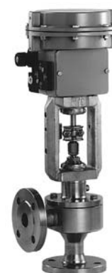
Fig. 2 · Válvula de control Tipo 3249-7, ejecución especial con prensaestopa de seguridad, cuerpo en bloque de material, con bridas, accionamiento neumático Tipo 3277-5 y posicionador i/p integrado Tipo 3767
