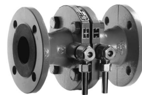
Messflansch Typ 92 Messflansch mit Flanschanschlüssen und Normblende · DN 20 bis 50 PN 16
