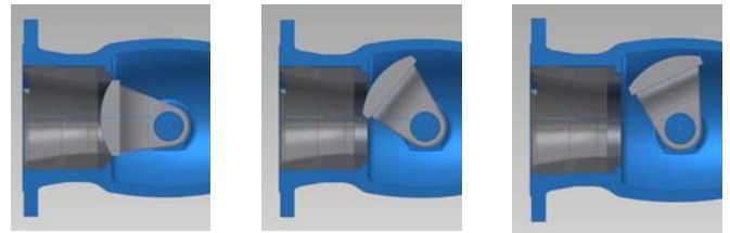
Bild 3 Kegelbewegung bei doppel-exzentrischer Lagerung
