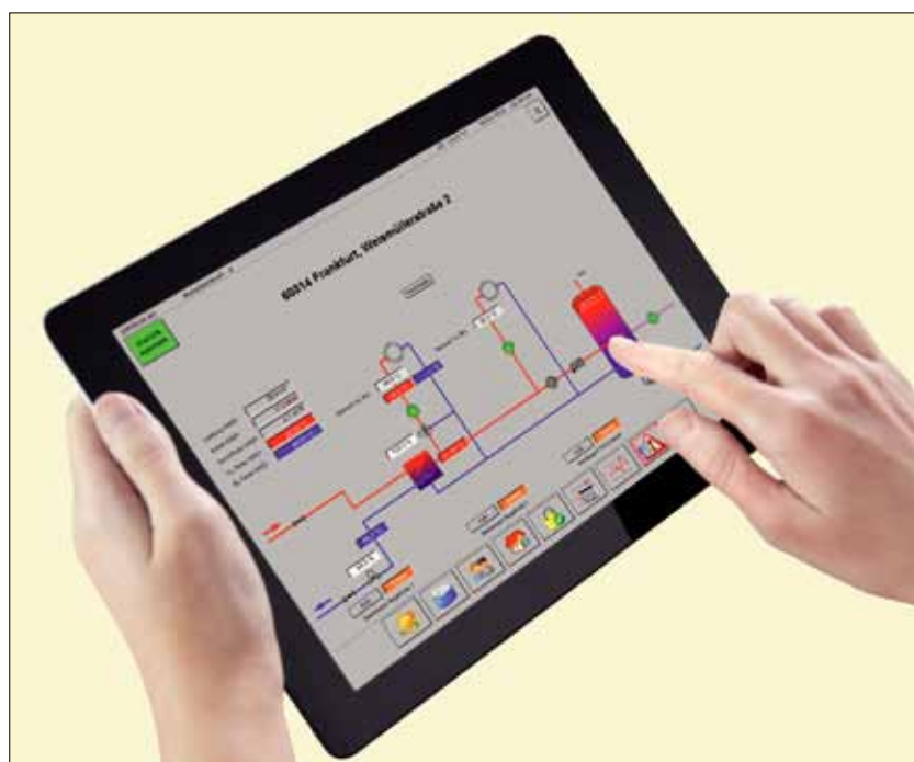
Bild 3. Mobiler Zugriff auf die Anlage über ein Tablet-PC
