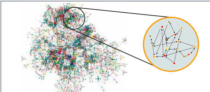
Abb. 3: Die Software stellt die Anlage als mathematischen Graphen dar, der die Beziehungen zwischen den Instrumenten beinhaltet.
